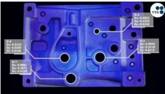
■独自の穴抽出技術で、プレス穴を高速・高精度測定
