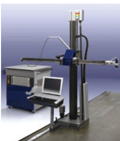
デザインで使用する クレイモデル加工機
