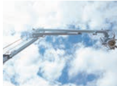
緊急離脱装置(ERS)の作動試験の風景
