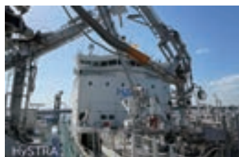
タンカーと接続中の鋼管型液化水素ローディングアーム
