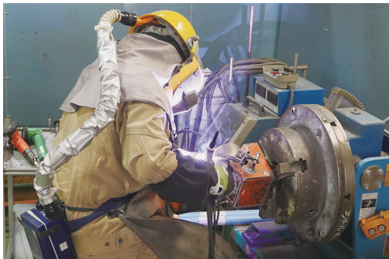
高精度が要求されるローディングアームの溶接
