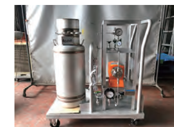
可搬タンク、付臭装置
